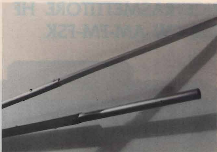
foto 1 In alto: preparazione degli elementi. In basso: giunzione del boom.
