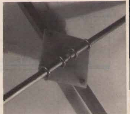
foto 3 Altro metodo per fissare gli elementi (escluso il radiatore) alla staffa e al boom. Notare le tegoline anti-schiacciamento.
